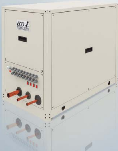
Panasonic nudi namjenski dizajnirano rješenje koje omogućuje brzu i jednostavnu ugradnju. Jedinica se sastoji od 5 kuglastih ventila, 30 l posude za pohranu i PLC-a koji se svi nalaze u IPS4 spremniku. Priključci na prednjoj jedinici omogućuju jednostavno ožičenje alarmnog priključka, pretvornika visokog / niskog tlaka i senzora odvoda temperature kondenzacijske jedinice(a).
